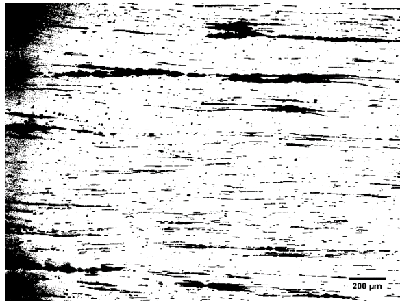
Figura 51: Filtro aplicado sobre micrografia com regiões de baixa iluminação. Foram criadas regiões que não correspondem a inclusões Fonte: Próprio autor, 2019.
