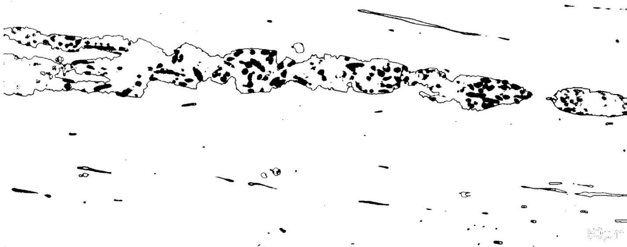
Figura 47: Aplicação do filtro evidenciando apenas a fase da wustita.
