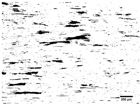
Figura 37 Amostra 145-T, com aumento de 100x. A fração volumétrica medida: 5,4%. Fonte: Próprio autor, 2019.
