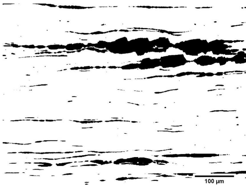
Figura 39: Amostra 145-L1, com aumento de 200x. A fração volumétrica medida: 12,3%. Fonte: Próprio autor, 2019.
