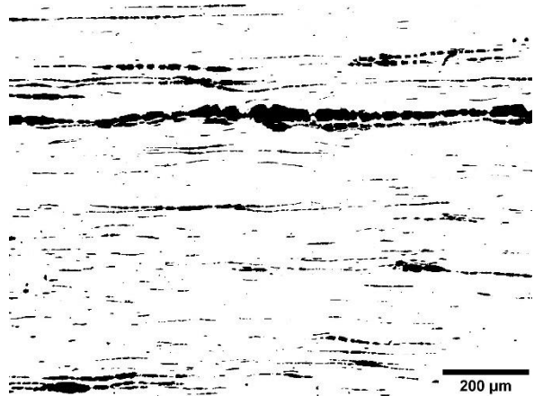
Figura 33: Amostra 145-L com 100x com filtro do ImageJ. A fração volumétrica medida: 8,3%. Fonte: Próprio autor, 2019.
