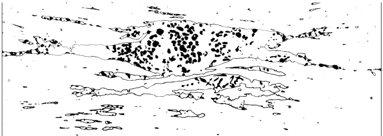
Figura 45: Aplicação do filtro threshold para evidenciar e quantificar apenas a wustita na inclusão
