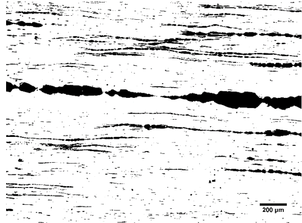
Figura 31: Amostra 145-L com 50x com filtro do ImageJ. A fração volumétrica medida: 10,6%. Fonte: Próprio autor, 2019.
