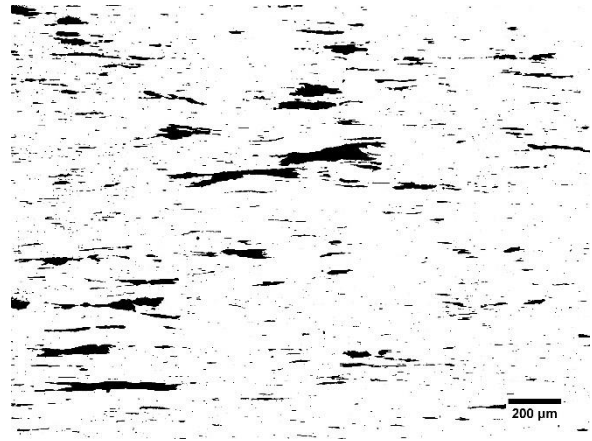
Figura 35: Amostra 145-T com 50x com filtro do ImageJ. A fração volumétrica medida: 6,6%. Fonte: Próprio autor, 2019.
