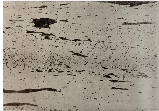
Figura 13: Ferro pudlado. Seção longitudinal atacada com ácido nítrico. Matriz de ferrita com inclusões de escória alongadas pela laminação. Aumento de 150x.
